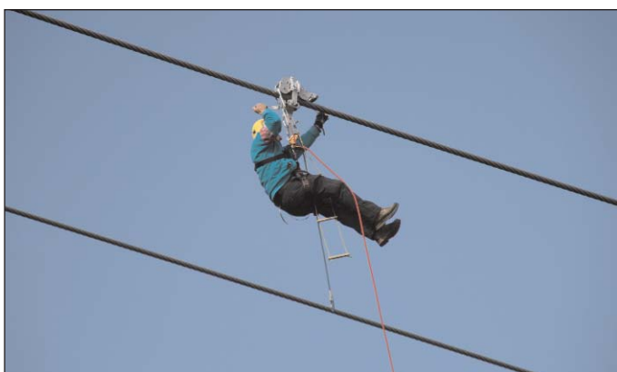
Der zweite Retter eines Teams ist mit dem IMMOOS Seilfahrggerät Typ SS1 ausgerüstet. Nach Ankunft der Retter auf der blockierten Kabine steigt ein Retter in die Kabine und orientiert die Fahrgäste über die Bergung. Danach bereitet er die ersten 2 Gäste für die Evakuierung vor. Der andere Retter auf dem Kabinendach richtet die Einrichtung zum Verschieben der Passagiere entlang dem Bahnseil ein.
